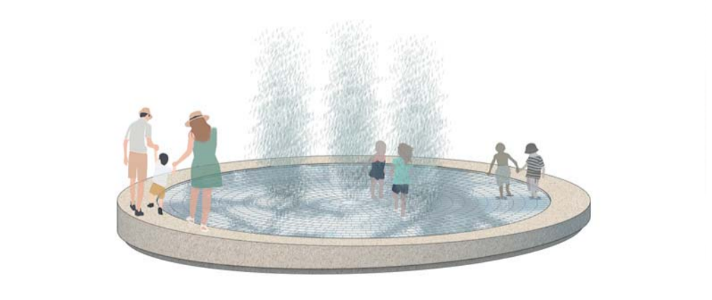
Les trois jets moussants sont proches du centre. Le réservoir tampon se trouve sous le bassin avec un accès légèrement excentré.
