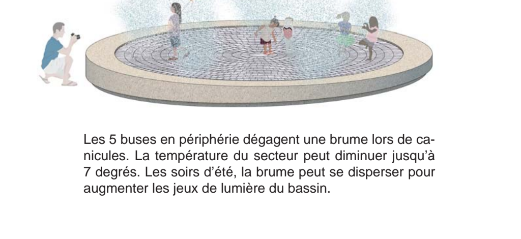
Les 5 buses en périphérie dégagent une brume lors de canicules. La température du secteur peut diminuer jusqu'à 7 degrés. Les soirs d'été, la brume peut se disperser pour augmenter les jeux de lumière du bassin.
